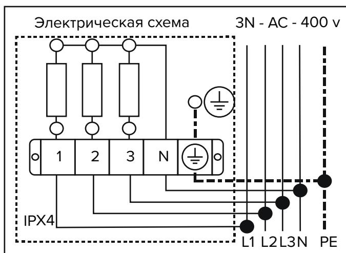
Схема подключения электрокаменки прикреплена к задней панели печи и соответствует данной иллюстрации.
