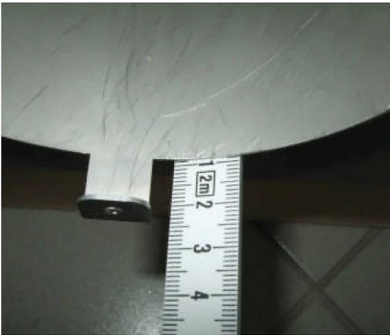
6. Отрегулируйте расположение переднего фланца. Нижняя часть смешивающей трубы должна быть примерно на 2 мм ближе к фланцу, чем верхняя часть трубы. Труба должна быть наклонена вперед, чтобы конденсат мог вытекать.
