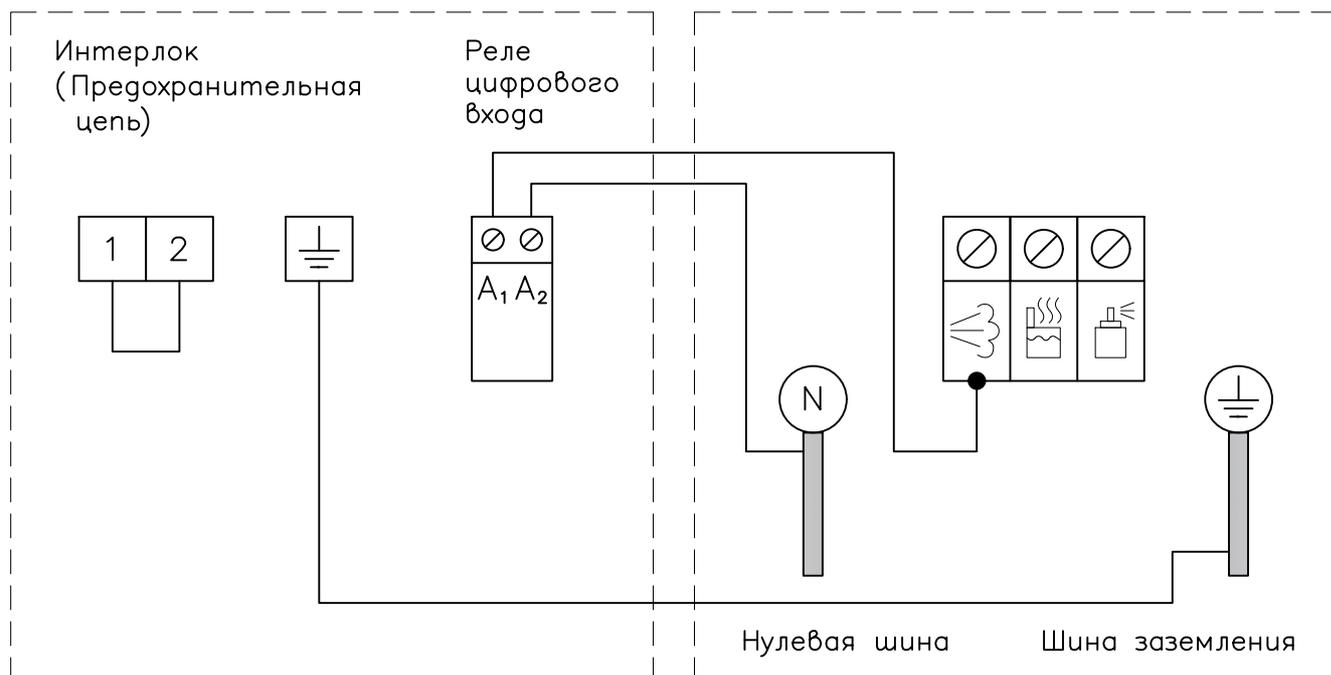
Инструкция по подключению парогенератора HygroMatik StandartLine к панели управления Fasel FCU X200–X400, Fasel FCU X000 Steam Design.
