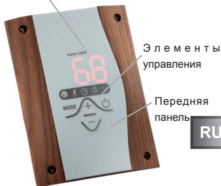
Рис. 4: Описание блока управления
