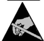
**Внимание:** несоблюдение этого указания может привести к повреждению устройства электростатическим разрядом. Электротехнические компоненты системы управления увлажнителем очень чувствительны к электростатическим разрядам. Для защиты этих компонентов при проведении всех монтажных работ необходимо принять меры, чтобы исключить повреждение устройства электростатическим разрядом (ESD-защита).
