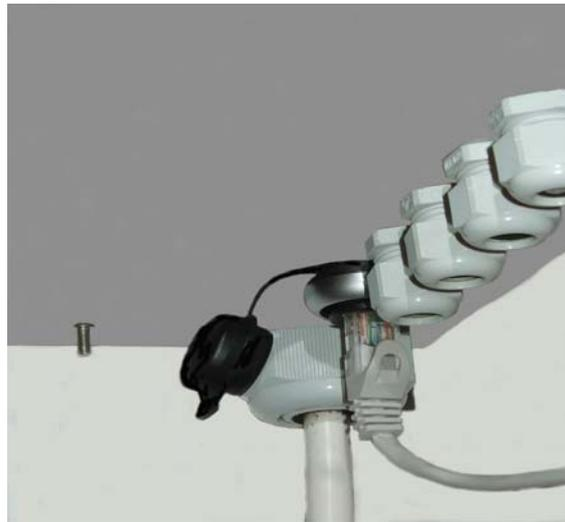
Подключение кабеля RJ45 с нижней стороны парогенератора
