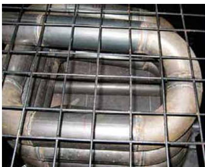
Металлическая сетка на поверхности спирального нагревателя
