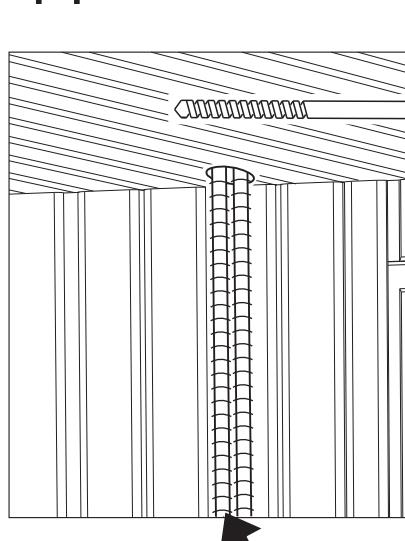
Värmebeständig kabel (170°C)
