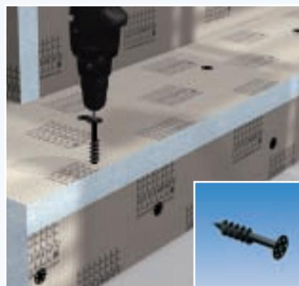
**LUX ELEMENTS®-FIX-SD – Специальный дюбель с резьбой** для соединения несущих элементов из жесткого пенопласта LUX ELEMENTS®. Выберите небольшое число оборотов, средний момент вращения! Бит типа PH3/PH2/PR2.
