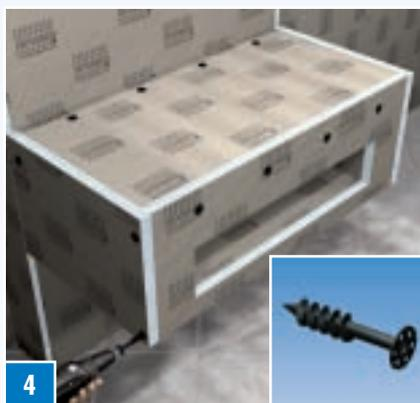
4 Готовый каркас фронтальной облицовки с помощью COL-MK наклеивается на несущую поверхность, таким же образом как боковины из ELEMENT-EL 30. Все дополнительно фиксируется с помощью FIX-SD 80. **ПРИМЕЧАНИЕ:** С помощью отвертки для винтов с крестообразным шлицом предварительно проколоть отверстия под дюбели.
