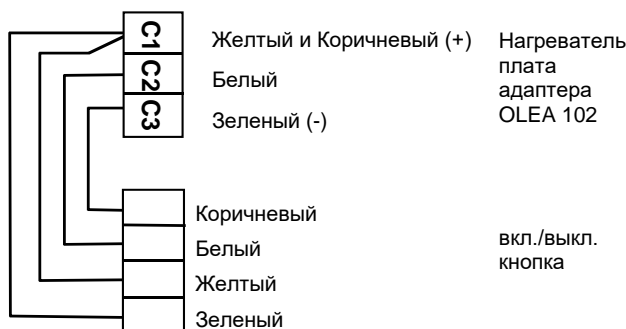
Подключение кнопки вкл./выкл.
